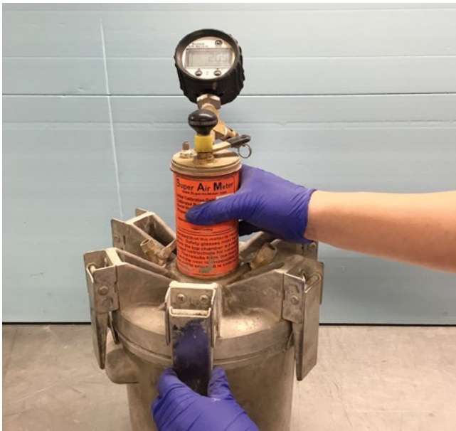
Figure 4.2. AASHTO TP 118 Super Air Meter (SAM)
