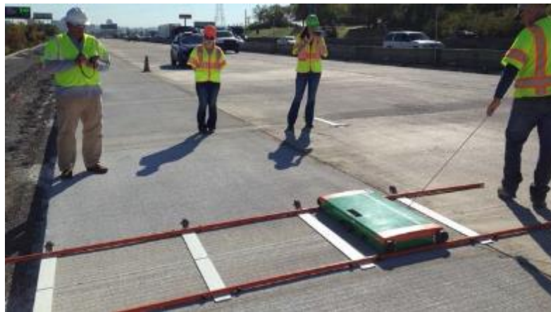
Figure 46: MIT Scan 2 in Operation on the Composite Section
